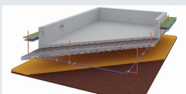
**基础接地板**
